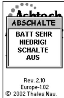
**Abb. 2.4** Alarm „Batterie sehr niedrig! Schalte aus“
