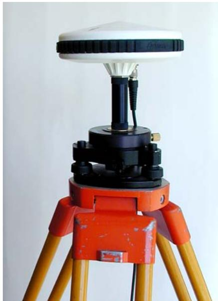
**Abb. 1.12** Stativ, Dreifuß und Dreifußadapter
