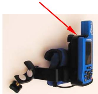
**Abb. 3.11** ProMark2 in die Gabel der Feldhalterung einsetzen
