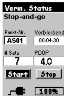
**Abb. 4.22** Vermessungsstatus – Display Stop-and-go
