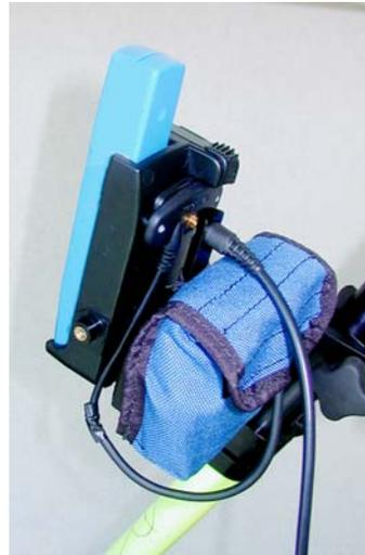
**Abb. 3.13** Antennenkabel, angeschlossen an Antenne und Empfänger
