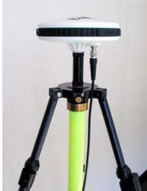
**Abb. 1.15** GPS-Stativ mit Verlängerung und GPS-Antenne
