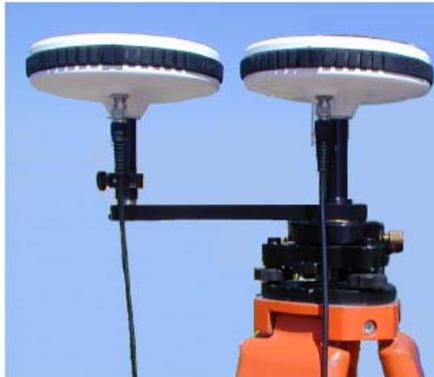
**Abb. 3.26** ProMark2 Antenne mit Initialisierungsstab
