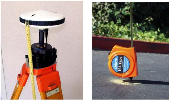
**Abb. 3.14** Messung der Antennenhöhe
