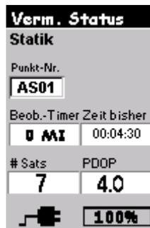
**Abb. 4.21** Vermessungsstatus – Display Statisch
