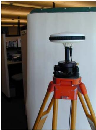
**Abb. 3.10** GPS-Antenne, die mit Hilfe von Dreifuß und Verlängerung auf einem Stativ angebracht ist
