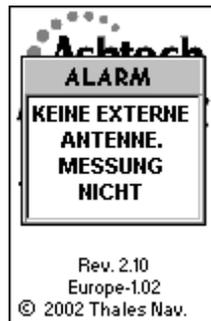
**Abb. 4.26** Alarmdisplays „Keine externe Antenne. Messung nicht möglich!“
