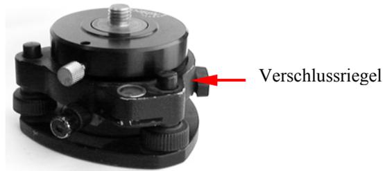
**Abb. 1.14** Dreifußadapter auf Dreifuß aufgesetzt
